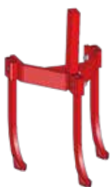
Griffon rigide 3 dents rigides à pointe diamant montant 50 x 30 mm hauteur 210 mm
