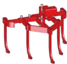
Griffon extensible rigide 5 dents rigides à pointe diamant dont 2 dents extensibles largeur de travail : 550 à 850 mm montant 60 x 30 mm gogue 45 ou 50 mm
