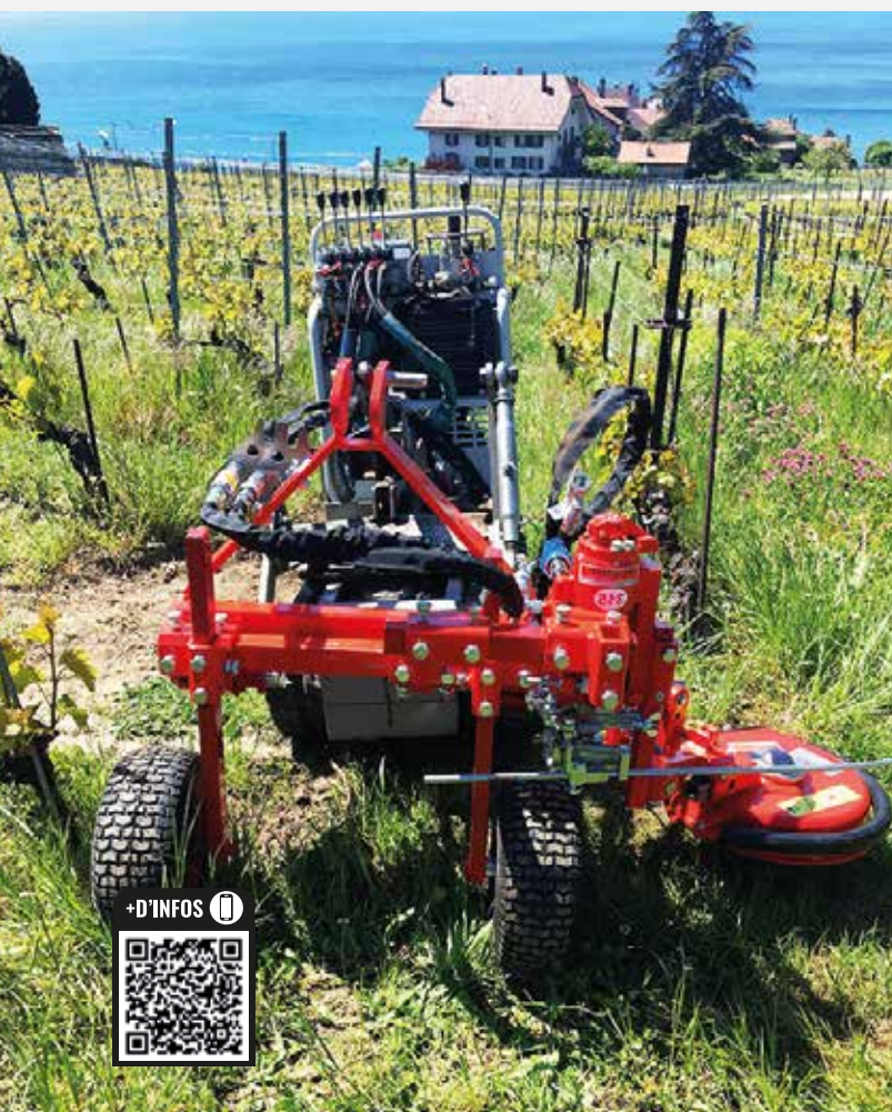
Porte-lames pourvu de 6 couteaux (pour tondo broyeurse Ø 600 mm & Ø 800 mm)
