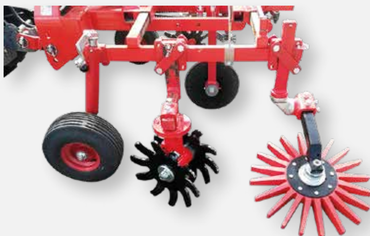
Bineuse à doigts « KULT-KRESS » Modèle rouge à montant 50 x 30 mm
