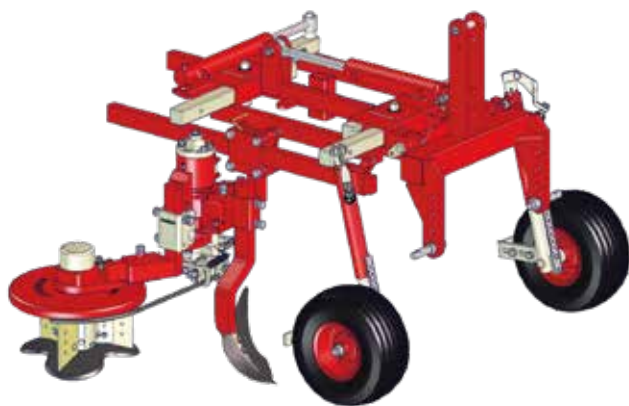
Exemple de montage cadre à relevage attelage 3 points équipé de servomoteur EVO 4* et de PÉTALMATIC+
